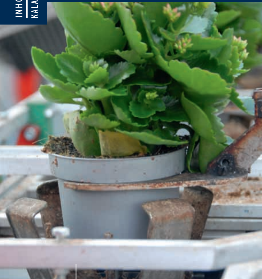
De vier vingers van de machine omklemmen de pot..
