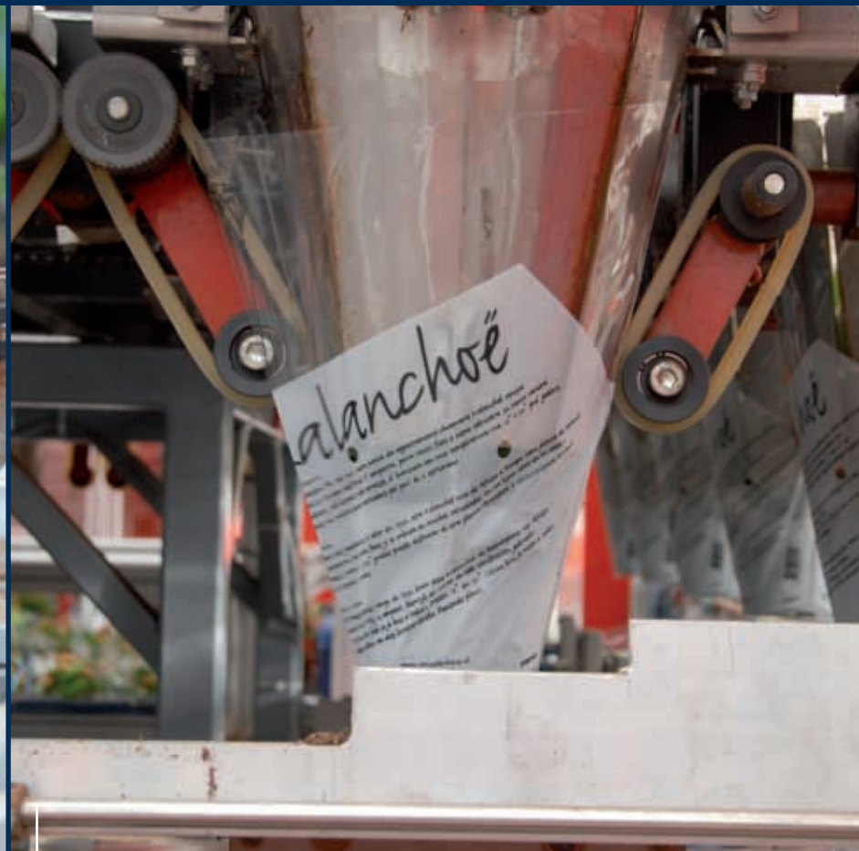
de hoes wordt van onderen om de beker getrokken...
