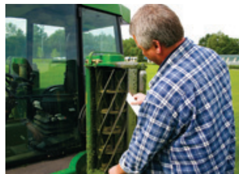
Geert van den Brand laat een goed afgestelde kooi zien: het papier wordt netjes tussen de kooi en het vaste deel afgeknipt zonder dat beide ijzeren delen elkaar raken.
