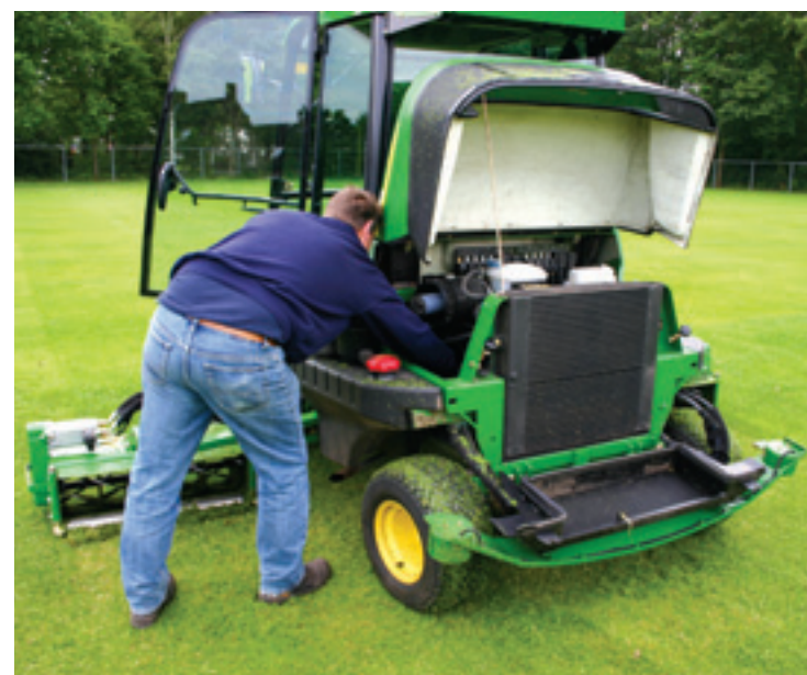
Alle onderdelen die dagelijks onderhoud nodig hebben kun je prima bereiken door de motorkap open te zetten. De oliepeilstok daarentegen zit wel erg diep weggestopt in de motor (rechts). Een mogelijke oplossing is deze te verlengen.
