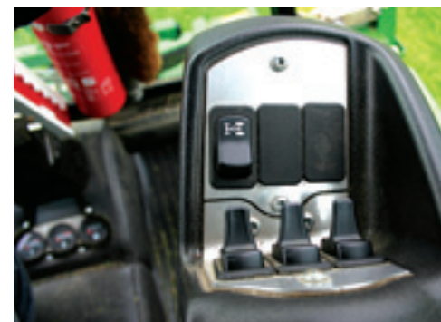
In de commando-arm in de leuning van de zitting is de bediening van de kooien geplaatst. De twee buitenste kun je apart heffen, de drie middelste gaan samen omhoog.
