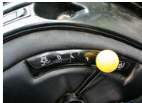
Door de gele hendel naar beneden te drukken verhoog je de snelheid van de maaikooien.
