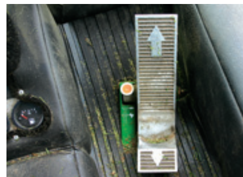
Met één pedaal bedien je beide richtingen. De voetknop dient om te schakelen tussen de hoge en lage groep.
