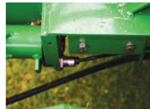
Aan iedere hefarm van de maaikooien is een sensor geplaatst. Doe je een kooi omhoog, dan stopt de betreffende kooi met maaien. Laat je hem weer zakken, dan begint hij gelijk weer te draaien.
