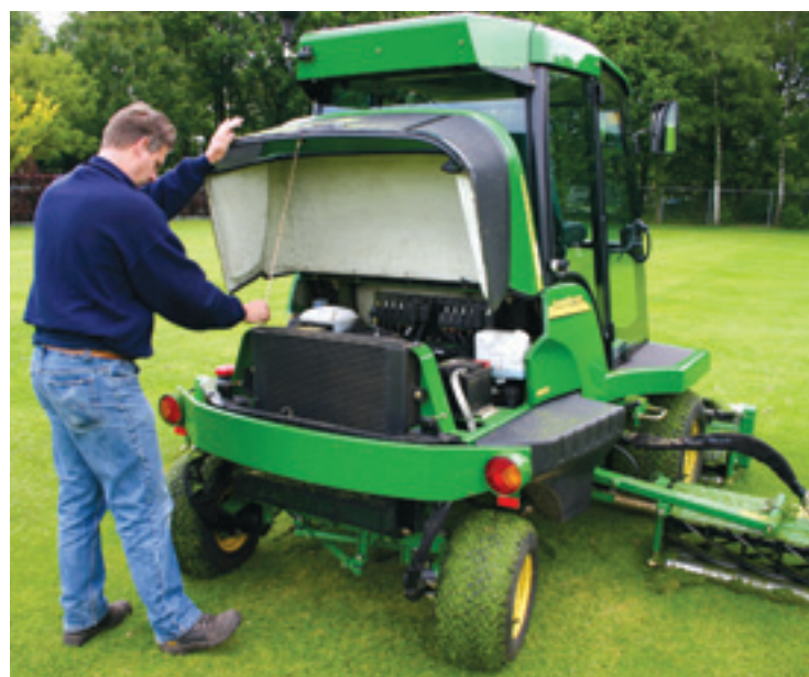
Alle onderdelen die dagelijks onderhoud nodig hebben kun je prima bereiken door de motorkap open te zetten. De oliepeilstok daarentegen zit wel erg diep weggestopt in de motor (rechts). Een mogelijke oplossing is deze te verlengen.
