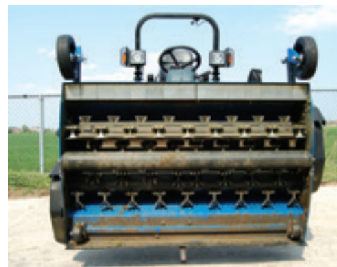
Het Musterdek heeft twee klepelassen met daartussen een grote looprol. Het rood-witte buisje onderaan is van de aftakas.
