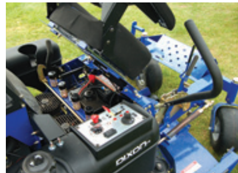
Voor makkelijk onderhoud aan het dek kan de voetplaat eraf. Onder de geveerde stoel kun je bij de accu en de hydrauliektank.
