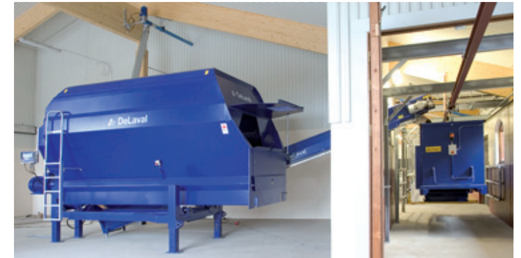
De stationaire mengbak wordt aangedreven met een elektromotor en is leverbaar in 8, 12 en 17 kuubs uitvoering.
