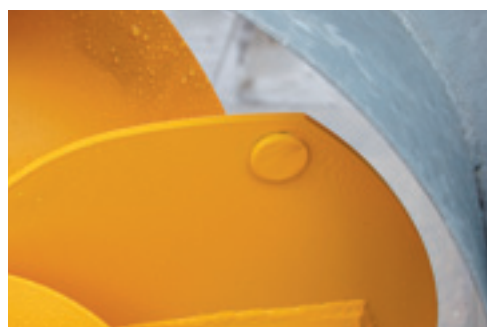
Om een schroefblad uit te balanceren worden er gewichtjes langs geplaatst zoals bij een autowiel.
