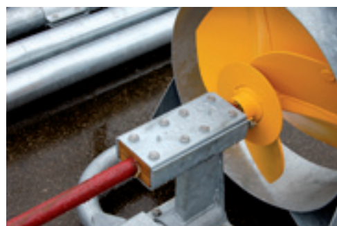
Reck heeft voor de diepe putten vanaf 2,5 meter een tweede schoep geïnstalleerd op de open draaiende as. Die draait door een houten lager.
