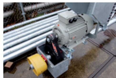
In nieuwe stallen wordt het meest gekozen voor een elektrische mixer tot zo'n 14,7 kW (20 pk). De V-snaar loskoppelen bij aftakasaandrijving is niet nodig.
