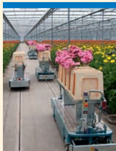
Een bloemenoogstwagen van Berg Product voor de oogst en het vervoer van snijbloemen.
