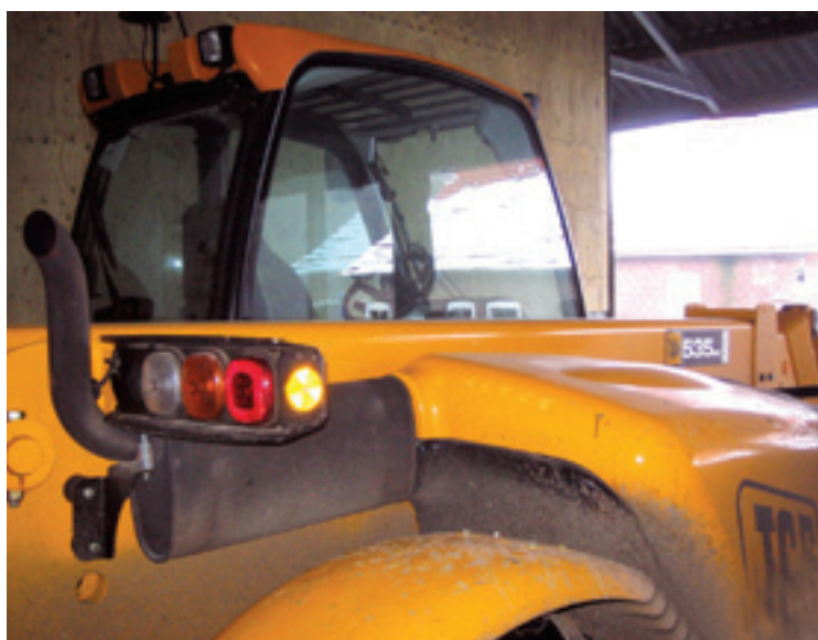
De JCB 535-60 Farm Special Super van Twan Schraven uit Overloon. Door de montage van de motor aan de zijkant en de laaggeplaatste giek is het zicht naar rechts en achter optimaal.
