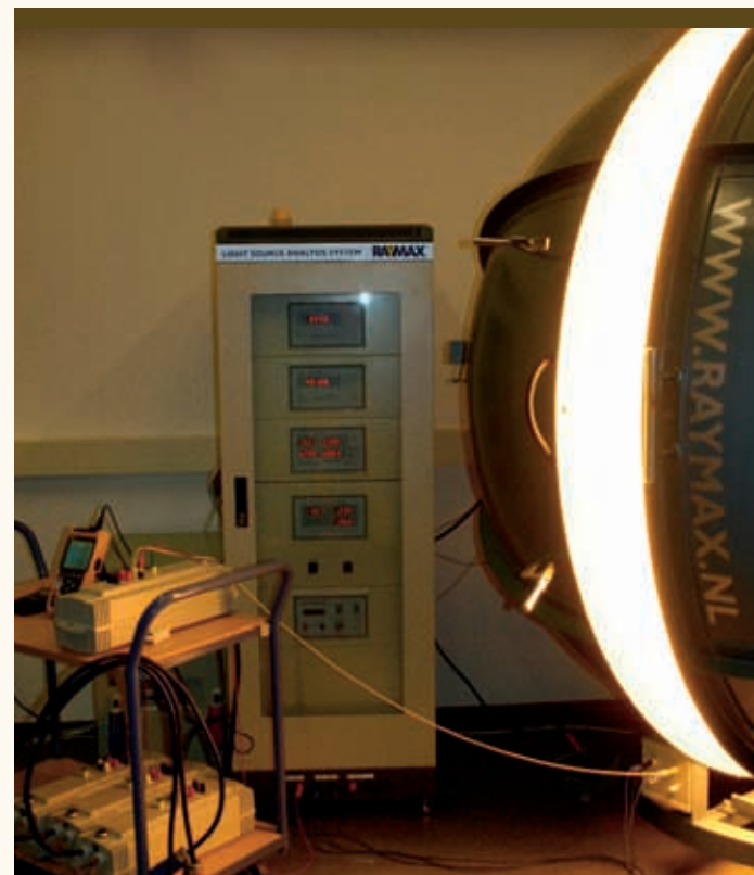
Het meten van de lichtopbrengst van een lamp gebeurt in de bol van Ulbrich.
