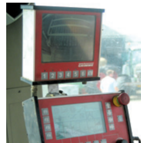
▲ Boven de standaard bedieningsterminal zit er bij Jaap Voogt een beeldscherm voor de camera's die hij op de machine heeft laten monteren.
