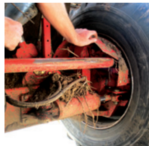
▲ Door de wielaandrijving kan de rooier onder bijna alle weersomstandigheden zijn werk doen. Als de trekker in de vrij staat duwt de rooier je vooruit.
