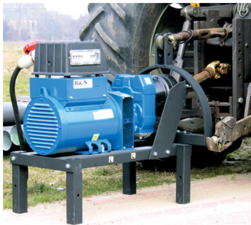
▲ Met een trekkeraggregaat is een storing in de stroomleverantie goed op te vangen en hoewel er vaak haast is geboden, mag aan veiligheid niet worden getornd. De aftakstussenas moet goed zijn afgeschermd.
