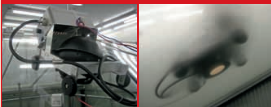
De zelfbewegende kleine integrerende bol van Ulbricht (links) die op het dak van de proefopstelling de reflectie meet. Rechts meet de bol de reflectie bij condens op het dek.
