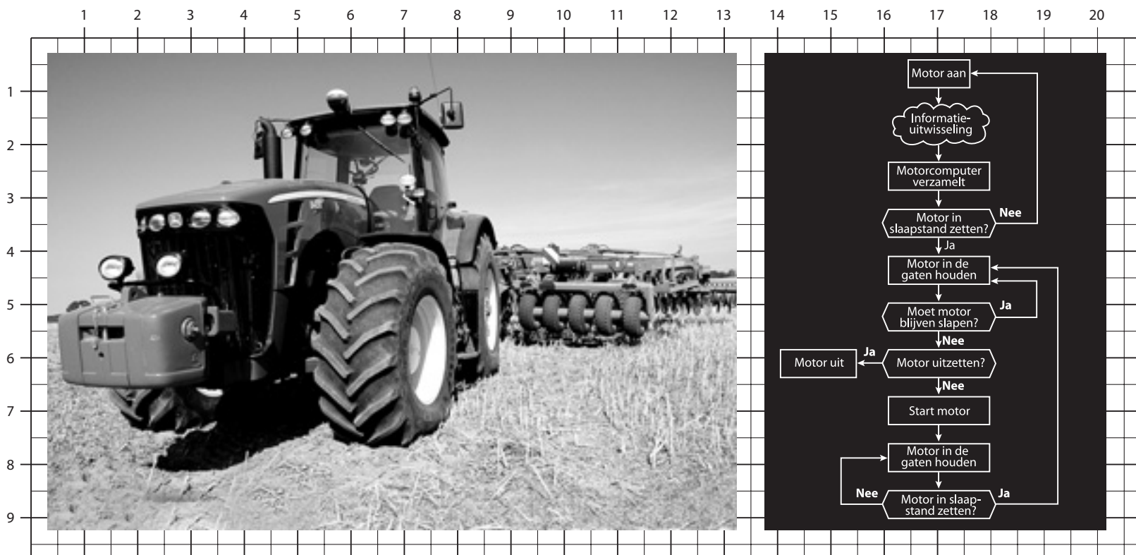
▲ Is de chauffeur even weg, dan schakelt de motor zichzelf uit.
