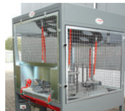
Wie veel trekkerwielen verwisselt, kan baat hebben bij de gereedschapsdrager voor een sleutel. Met een soort krik, lange as en een hefboom moeten vastzittende moeren eenvoudig los te draaien zijn.
