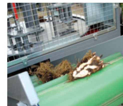
De scheurmachine is compact en werkt met een draaitafel. Je plaatst een wortelkluit, een stempel drukt de kluit naar beneden door een stermes en de gesneden stukken komen op een afvoerbands.
