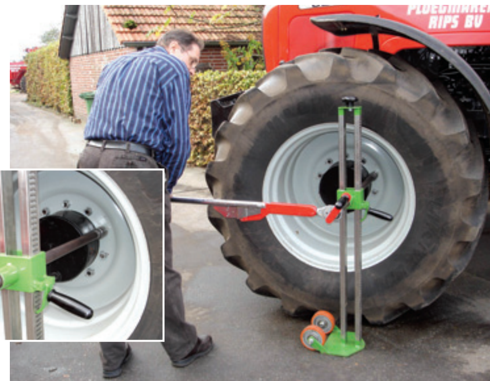
Wie veel trekkerwielen verwisselt, kan baat hebben bij de gereedschapsdrager voor een sleutel. Met een soort krik, lange as en een hefboom moeten vastzittende moeren eenvoudig los te draaien zijn.
