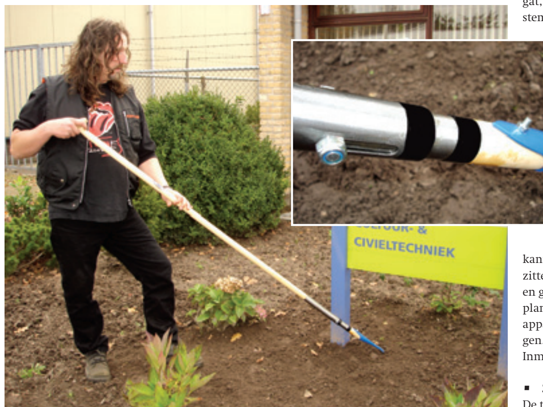
Schoffelen met schokdemper in de steel kan arm-, pols- en elleboogklachten voorkomen. Door een veer in een ijzeren huls kan de steel inschuiven wanneer je tegen een obstakel botst waardoor deze de grote klap opvangt in plaats van je arm.
