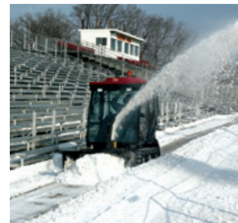
In tegenstelling tot de bestaande Groundsmaster heeft de nieuwe GM 7200 geen stuurwiel, maar twee hendels. Een zeroturnmaaier dus. Speciaal is de mogelijkheid om de maaier om te bouwen tot een soort sneeuwmobil op rupsen. Er komt dan een rupsonderstel onder, een cabine en aan de aftakas kan dan bijvoorbeeld een sneeuwrees.
