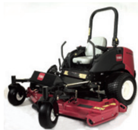
In tegenstelling tot de bestaande Groundsmaster heeft de nieuwe GM 7200 geen stuurwiel, maar twee hendels. Een zeroturnmaaier dus. Speciaal is de mogelijkheid om de maaier om te bouwen tot een soort sneeuwmobil op rupsen. Er komt dan een rupsonderstel onder, een cabine en aan de aftakas kan dan bijvoorbeeld een sneeuwrees.
