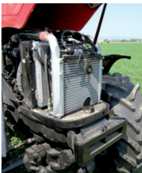
▲ De Stage III motor in de viercilinder heeft grotere koelpakketten die minder toegankelijk zijn uit te vouwen dan bij de zescilinder.
