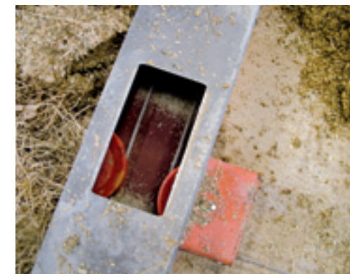
De staalkabels, bevestigd op de voergang (links) komen door wielen de schuif binnen (rechts).
