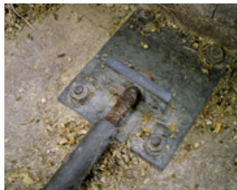
De staalkabels, bevestigd op de voergang (links) komen door wielen de schuif binnen (rechts).
