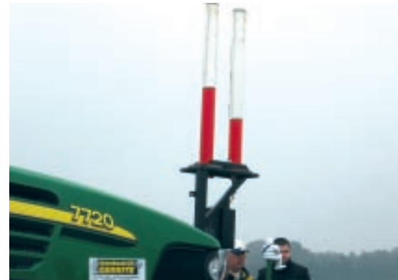
Foto 5. De trekker van loonbedrijf Gerrits met daarachter een 5,1 meter brede cultivator van Evers deed twee bewerkingen. Met een bandspanning van 0,8 bar (linkerbuis) werd 19% minder brandstof verbruikt dan met een bandspanning van 1,8 bar (rechterbuis). Tevens was bij 0,8 bar de capaciteit 14% groter door minder wielslip.
