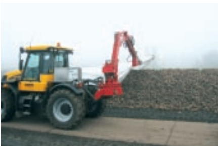
Foto 7. De heer Klünder uit Duitsland toonde een machine voor het afdekken van een bietenhoop met vliesdoek. Dit ging zeer snel en gemakkelijk. De bietenhoop moet hiervoor wel langwerpige en maximaal 9 meter breed zijn.
