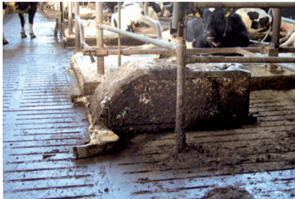
De JOZtech op het Hightechbedrijf van de Waiboerhoeve. De connector van de oplader bevindt zich op de vloer. Koeien mogen daar niet bij kunnen.
