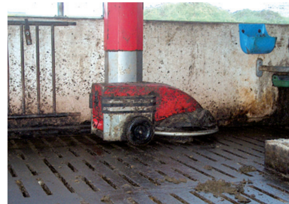
De Lely Discovery laadt zich op bij een paal in de stal. Op het Hightechbedrijf veegt het apparaatje de vloer van de jongveestal aan.
