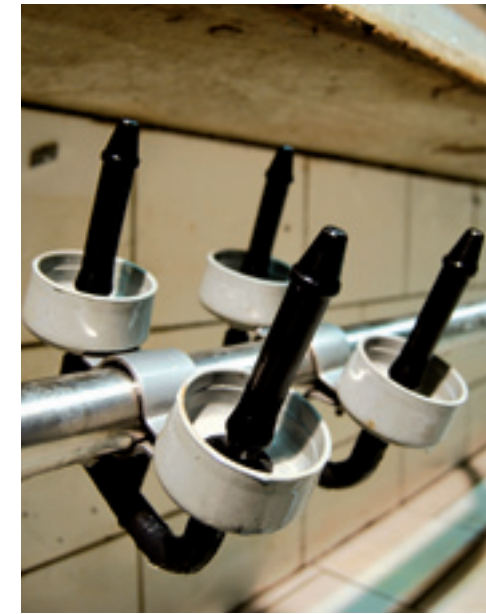
De spoeljetters van de Klesan installatie reiken tot diep in de tepelvoering.
