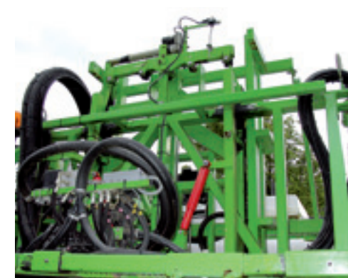
▲ Bij CHD is de boom trapezium pendelend opgehangen. Twee verstelbare schokdempers zorgen voor demping van de slingering.
