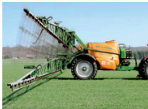
▲ In deze opstelling, parallellogram lift van Amazone, is goed te zien welke weg de spuitboom aflegt en dat hij in geheven positie korter op het werktuig zit dan in werkstand.
