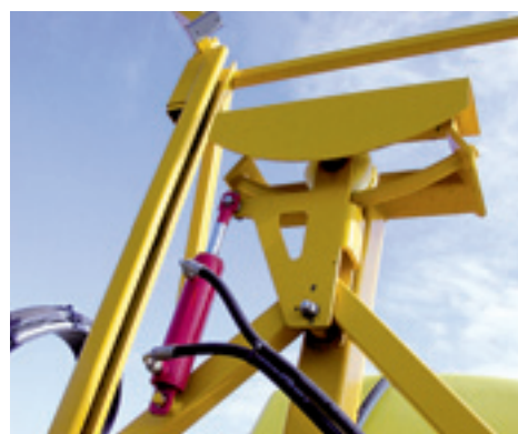
▲ Dubex hanteert een omgekeerd afrolprincipe, waarbij de balanscorrectie tussen boom en ophangpunt zit. Een demper zorgt voor stabiliteit.
