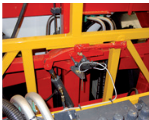
▲ Het afrolprincipe van Agrifac valt op door de eenvoudige constructie. Weinig buffers of stabilisatoren. Bij het scheefhangen van de machine rolt de halve maan onder de spuitboom door.
