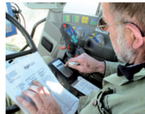
▲ Bij grote verandering in rijnsnelheid moet je doseerplaatjes verwisselen. Via een tabel kun je de juiste plaatjes uitrekenen.
