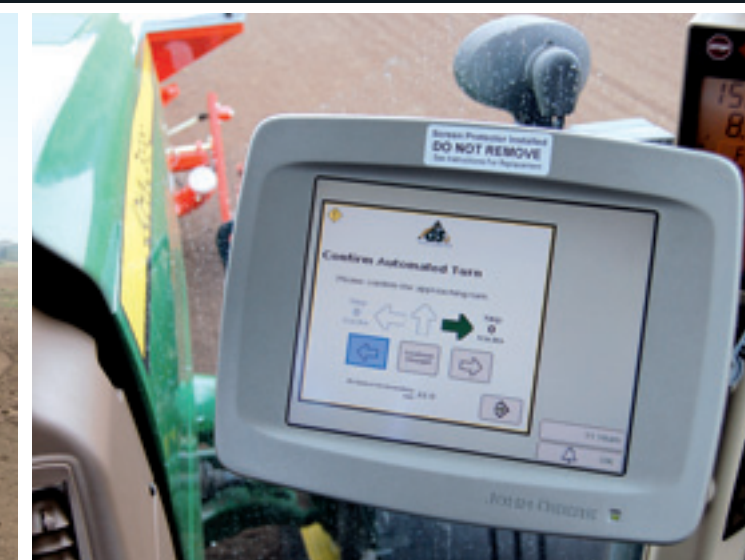
▲ Aan het eind van elke werkgang krijg je een alarm en bovenstaande vraag. Je kunt de richting bevestigen of de andere kant op drukken.
