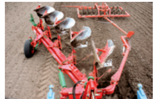
▲ De eerste schaar verstelt niet mee met de hydraulische breedteverstelling.
