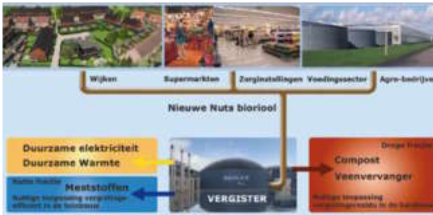
Figuur 9: Het Nieuwe Nutsbioriool. Toiletspoeling en organisch afval (van onder andere huishoudens, restaurants, ziekenhuiskeukens, supermarkten, tuinbouw en voedingssector) wordt per buis getransporteerd naar een vergister. De substantie wordt gezuiverd en omgezet in nuttige producten: energie en meststoffen.
