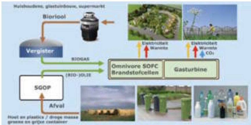
Figuur 8: Procesontwerp voor een duurzame energiekringloop. Een apart riool (bioriool) voorziet in de af- en aanvoer van vergistbare reststromen. Niet-vergistbare stromen zoals stro en koolzaadschroot worden zover mogelijk in synthesegas en olie omgezet (SGOP, synthesegas- en olieproductie). Gesorteerde plastics kunnen ook voor verolieing in aanmerking komen. De reststromen voeden de combinatie van een hete brandstofcel (SOFC) met gasturbine. De zuivere CO 2 die daarbij vrij komt, wordt toegepast in gesloten tuinbouwkassen.
