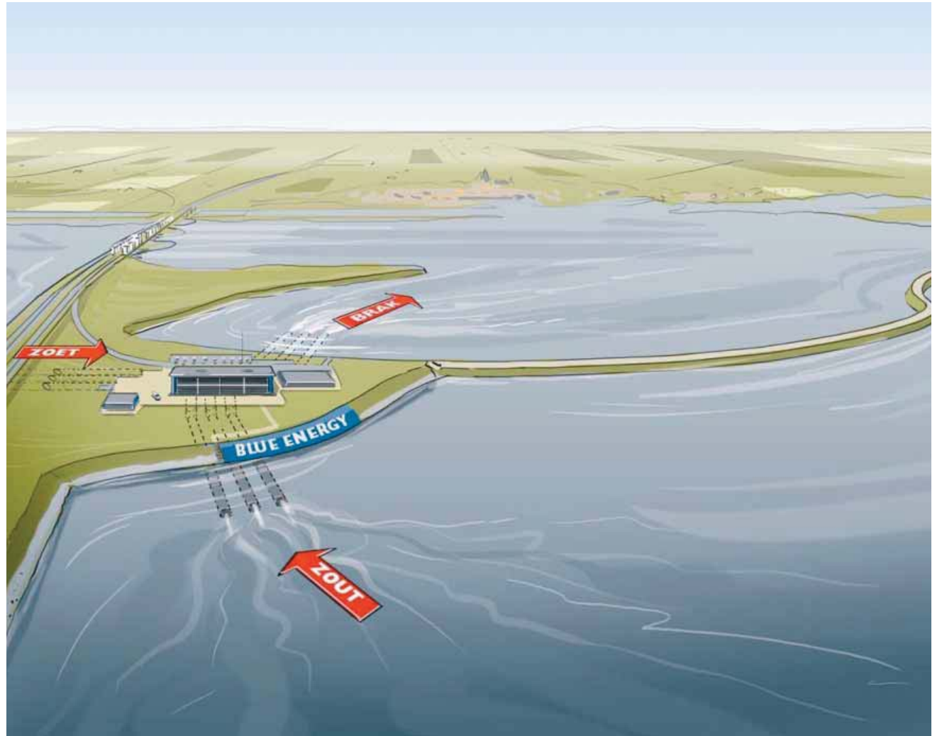
Deze constructie bij de afsluitdijk combineert blauwe energie met nieuwe natuur. Bert Hamelers: ‘We kunnen zo makkelijk ons ‘afval’ - brak water - kwijt in het meer, en op hetzelfde moment ontwikkelen we natuur.’
