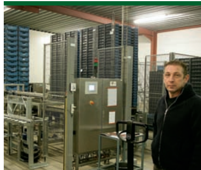
Werner Goormans: "Het handmatig opzetten van klapkratten vonden we te arbeidsintensief daarom hebben we deze kratten-opzetmachine gekocht."
