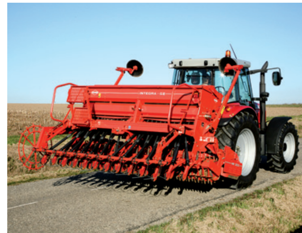
▲ Met een aanbouwwerk tuig in de hef zijn er op de weg al snel frontgewichten nodig. Volgens de verkeerswet moet namelijk ten minste 20% van het ledige gewicht van de trekker op de stuurwielen rusten.
