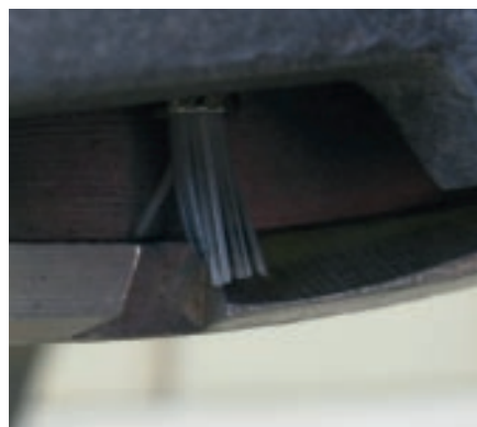
Foto 2. Uitwerpborsteltje van een Monosem uit de Meca-serie. Het borsteltje dat het zaad uit de cellen veegt, moet men regelmatig controleren en - indien nodig - bijstellen.
