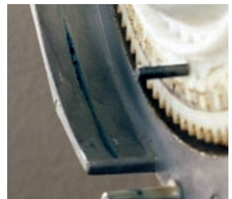
Foto 3. Slijtgroef bij een Monozentra. Hierdoor kunnen de pillen eerder de cel uit de zaaischijf verlaten. Dit veroorzaakt een onregelmatigere zaaiafstand en bij een nog diepere groef ook breuk van de pillen.
