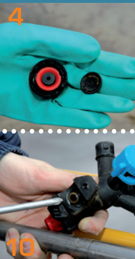
4 Wanneer de dophouders zijn gedemonteerd, kun je deze meteen controleren op een goede afdichting tussen de dophouder en de spuitleiding.
