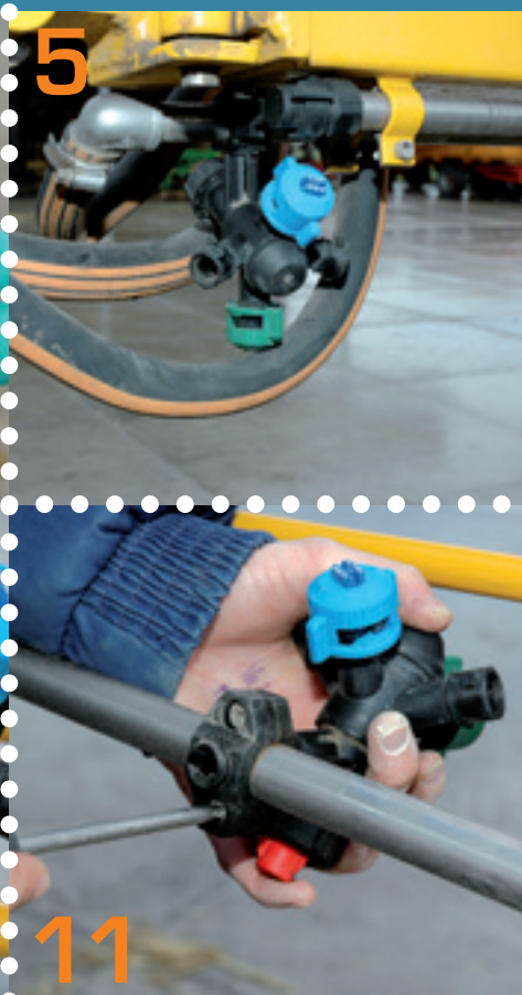
5 Voordat je de dophouders monteert, kun je de afdichting invetten met zuurvrije vaseline. Ook het invetten van de bevestigingsboutjes met kopervet vergemakkelijkt het demonteren bij een volgende keer.
