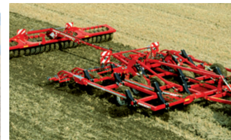
▲ Lange, meerbalkige machines hebben de meeste potentie om de ploeg te vervangen. Want hoe langer de cultivator is, hoe meer grond deze kan meenemen en herverdelen. Bij de Horsch Terrano FG met vier rijen cultivatoren is een transportonderstel onmisbaar.
