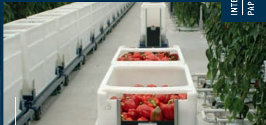
Metazet vervoert de containers langs een kettingbaan naar de verwerkingsruimte.
