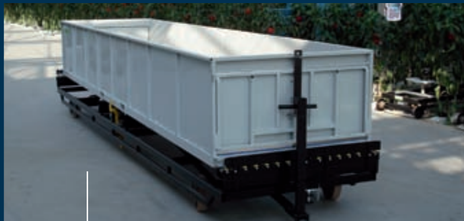
Buitendijk/Slaman gebruikt een I-profiel voor het transport van de containers.
