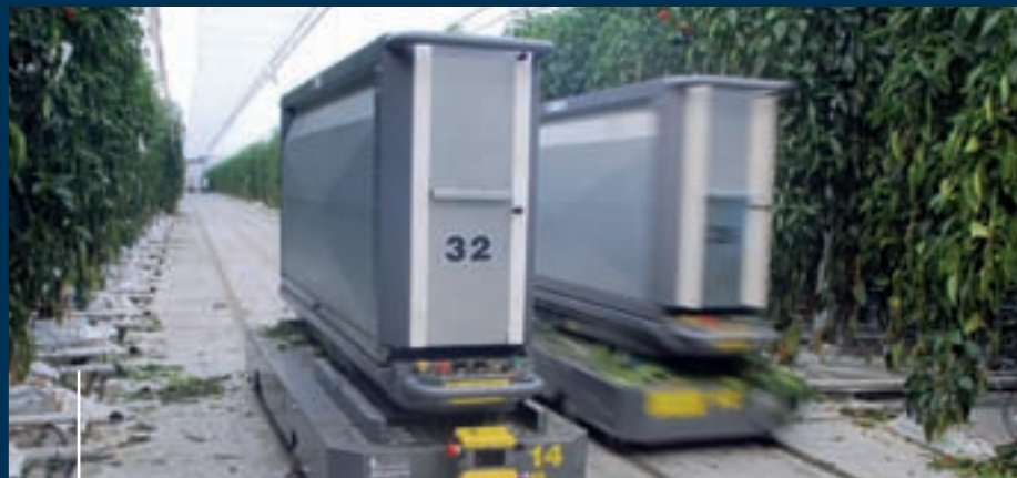
Bogaerts gebruikt voor het vervoer onder andere een inductiedraad.
