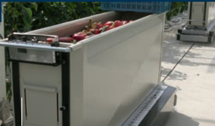
Berg Product vervoert de containers via een U-vormig geleidingsprofiel.
