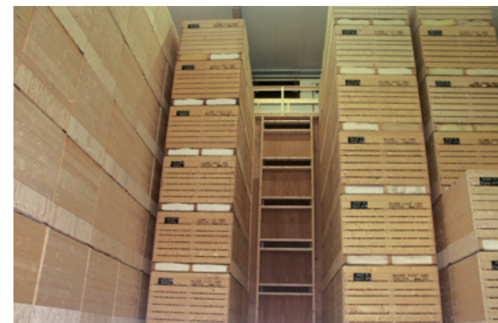
▲ Kisten voor een droogwand moeten eigenlijk een dichte zijkant hebben.
