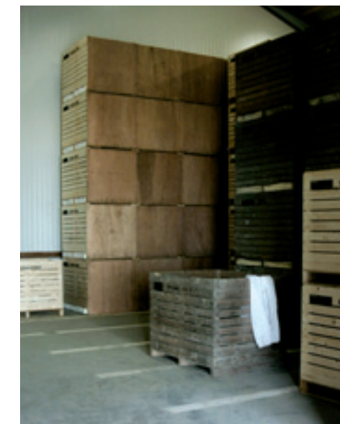
▲ Verschillende kisten door elkaar kan problemen geven met de luchtverdeling.
