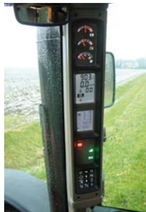
▲ Alle trekkeergegevens zijn af te lezen in de A-stijl van de cabine. Achter het stuur is nu alleen nog een handschoenen- of rommelvak te vinden.
