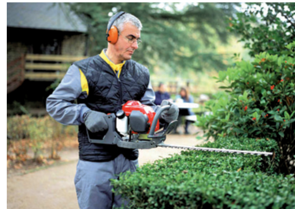
De Honda met M4 motor, tweede generatie viertakt, stoot heel weinig schadelijke stoffen uit. Wel is het motorhuis iets groter en zwaarder dan bij een tweetakt, waardoor de balans een beetje uit het lood kan zijn. De smering is via olieniveau; een apart oliereservoir met rotor maakt level zodat de smering in alle standen goed is.
