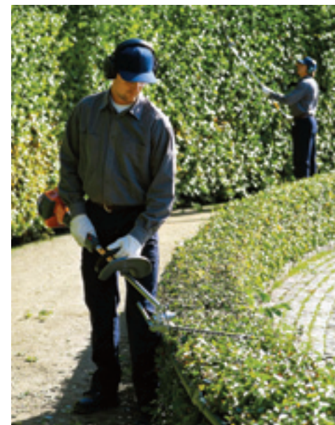
Bij hoge groene muren of lage hagen is een stokheggen- schaar, of deze Husq- varna 325HDA55x, met verstelbare hoekinstelling handig en beter voor je lichaam.
