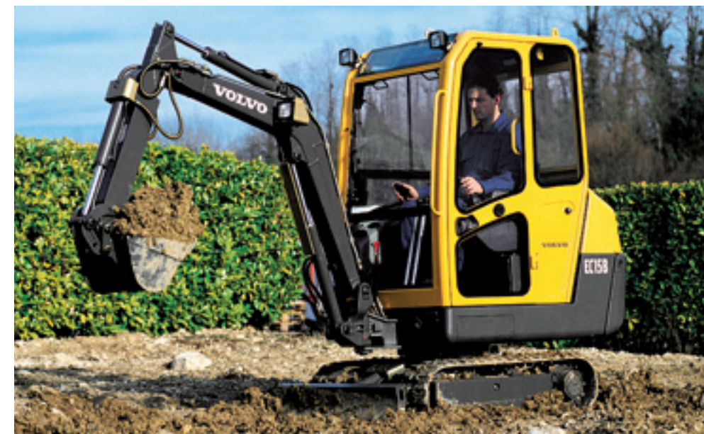
Volvo heeft een load sensing pomp waarmee alle functies tegelijk zijn uit te voeren. Recht rijden en tegelijk graven is geen probleem.
