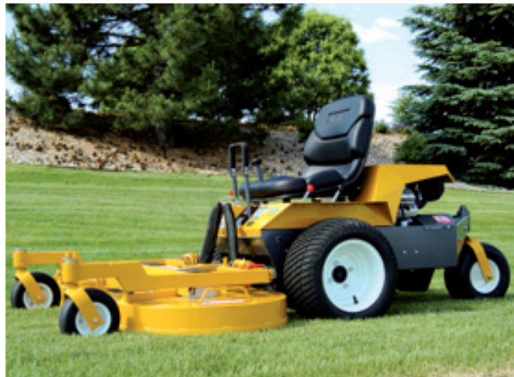
Bij de zero-turn die er uitziet als een frontmaaier zit het maaidek helemaal voor de bestuurder. Hierbij is het maaidek eenvoudig af te nemen zodat je andere werktuigen voorop kunt monteren aan de aftakas.
