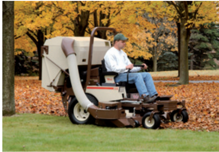
Op sommige zero-turns kan ook een opvangsysteem. Je kunt er in het najaar dan ook bladeren mee opzuigen.
