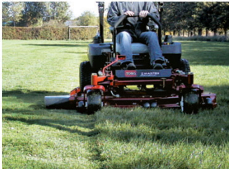
Het Toro TurboForce maaidek heeft een instelbare grasuitwerp middels een hendel en een rubberen uitwerpkanaal. Met een recyclerkit is het dek zonder gereedschap van mulch naar zijlosser te veranderen bijvoorbeeld voor het maaien van lang gras.
