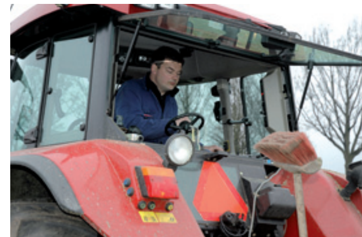
Bij Steyr, Case IH en New Holland kan het stuur over een rail opzij schuiven. Door de uitbouw van de cabine is er voldoende beenruimte en staan er normale pedalen. In de cabine-stijl zijn enkele extra functies opgenomen, een groot deel van de bedieningsfuncties blijft op de originele stoel-leuning zitten. Het originele stuur wordt opgeklapt.
