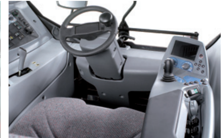
De stoel omkeren kan bij Valtra altijd. Af fabriek is er ook Twin Trac, dat betreft een stuur en rem en koppelpedaal achterin geleverd. Het stuur is ook weg te klappen en de hendel voor de omkering vooruit-achteruit zit ook aan deze stuurkolom. Dit voorjaar introduceert Valtra een vernieuwde Twin Trac. Belangrijkste verschil is dat dan het stuur in het midden komt te staan.
