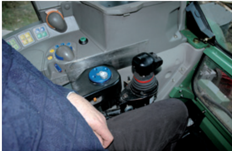
Op de Fendt 700- en 800-serie met omkeersysteem vervangt Neumaier het stuur door een klein wielletje in de linker armleuning. Er komt een digitaal kastje dat een aantal functies van het dashboard overneemt. Bij deze trekker zijn de armleuning van de leverancier van de houtkraan overgenomen, daarom is ook de variohendel apart en hoger geplaatst. Voor voldoende ruimte voor de stoel wordt het originele stuur ook opgeklapt.
