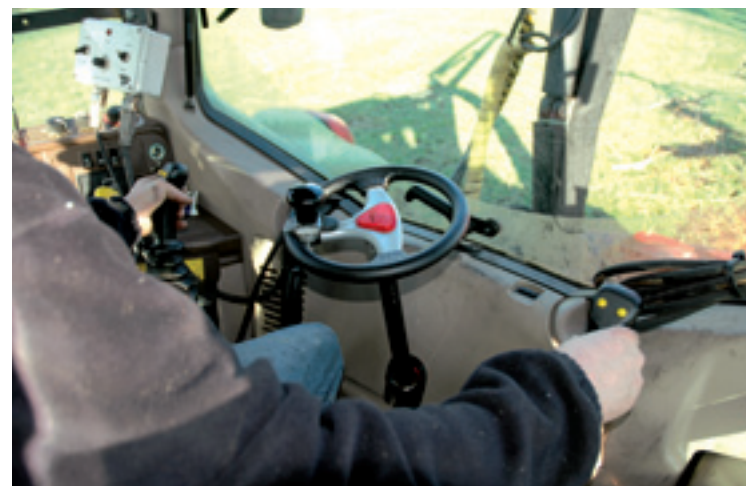
Mechanisatiebedrijf Schipper in Putten heeft enkele John Deeres omgebouwd. Dan komt er een afneembaar stuur achterin te staan. Dat bestuurt een orbitrol terwijl andere systemen vaak elektrisch sturen. Met de Autopower hendel laat de trekker zich eenvoudig rijden en zijn rem en koppeling nauwelijks meer nodig.
