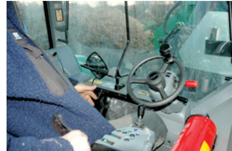
De stoel omkeren kan bij Valtra altijd. Af fabriek is er ook Twin Trac, dat betreft een stuur en rem en koppelpedaal achterin geleverd. Het stuur is ook weg te klappen en de hendel voor de omkering vooruit-achteruit zit ook aan deze stuurkolom. Dit voorjaar introduceert Valtra een vernieuwde Twin Trac. Belangrijkste verschil is dat dan het stuur in het midden komt te staan.
