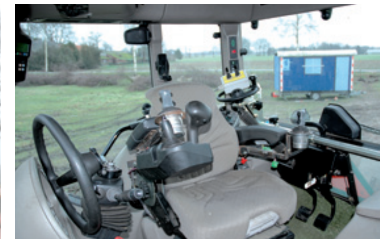
Bij Steyr, Case IH en New Holland kan het stuur over een rail opzij schuiven. Door de uitbouw van de cabine is er voldoende beenruimte en staan er normale pedalen. In de cabine-stijl zijn enkele extra functies opgenomen, een groot deel van de bedieningsfuncties blijft op de originele stoel-leuning zitten. Het originele stuur wordt opgeklapt.
