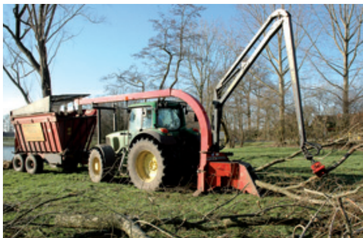
Mechanisatiebedrijf Schipper in Putten heeft enkele John Deeres omgebouwd. Dan komt er een afneembaar stuur achterin te staan. Dat bestuurt een orbitrol terwijl andere systemen vaak elektrisch sturen. Met de Autopower hendel laat de trekker zich eenvoudig rijden en zijn rem en koppeling nauwelijks meer nodig.
