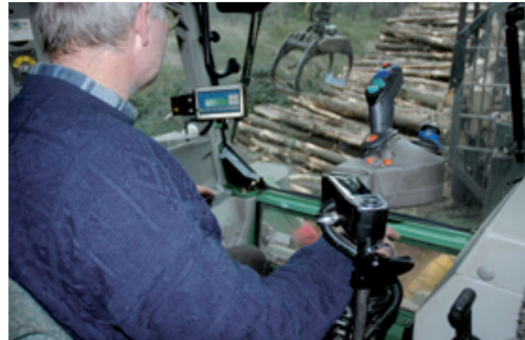
Op de Fendt 700- en 800-serie met omkeersysteem vervangt Neumaier het stuur door een klein wielletje in de linker armleuning. Er komt een digitaal kastje dat een aantal functies van het dashboard overneemt. Bij deze trekker zijn de armleuning van de leverancier van de houtkraan overgenomen, daarom is ook de variohendel apart en hoger geplaatst. Voor voldoende ruimte voor de stoel wordt het originele stuur ook opgeklapt.
