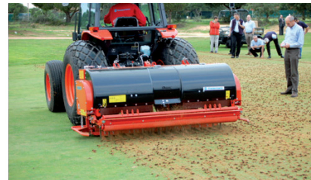
Met de Wiedemann XDI-8 penbeluchter kun je met 3,2 km/h zo'n 27 cm diep en holle pennen tot 35 mm snel beluchten.
