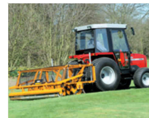
De slitmessen van de Sisis staan onder een hoek op de schijven. Hierdoor gaan de messen als een anker door de grond en snijden ook de wortels door.
