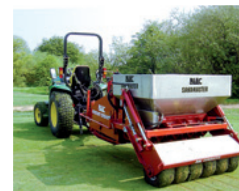
De Blec schudbeluchter is leverbaar met de Sandmaster om in één werkgang sleuven te vullen met zand.
