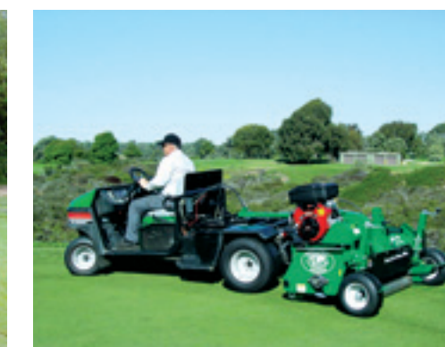
Nieuwe penbeluchter in Nederland is de Planetair. Door de lusvormige beweging van de pennen wordt een groot ondergronds oppervlakte bewerkt, terwijl het spel minimaal wordt beïnvloed.
