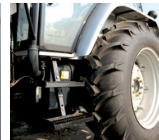
Achter de twee treetjes naar de cabine gaat een 150 liter grote dieseltank schuil.
