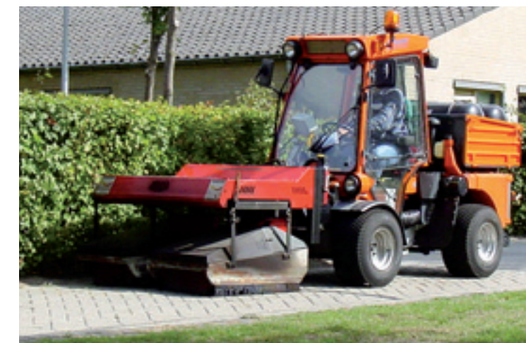
Bij de Hoaf Weedstar 50i kun je de branders uitschuiven. Zo is naast de trekker te branden. Het gasverbruik is elektrisch vanuit de cabine te regelen.
