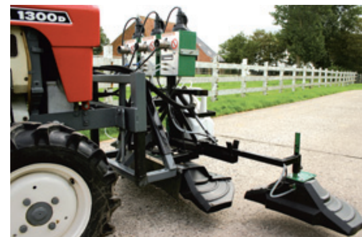
Ook met de Mankar spuitmachines voor puur Roundup mag je onkruid op verhardingen bestrijden. Door selectief te spuiten kunnen deze machines nog zuiniger werken.
