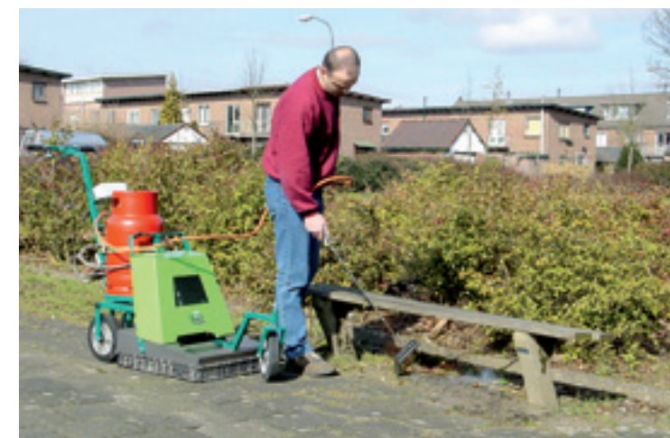
Onkruidbranders zijn voor licht tot matig begroeide bestrating. Tevens onttrekt het de kiemkracht van het aanwezige zaad.
