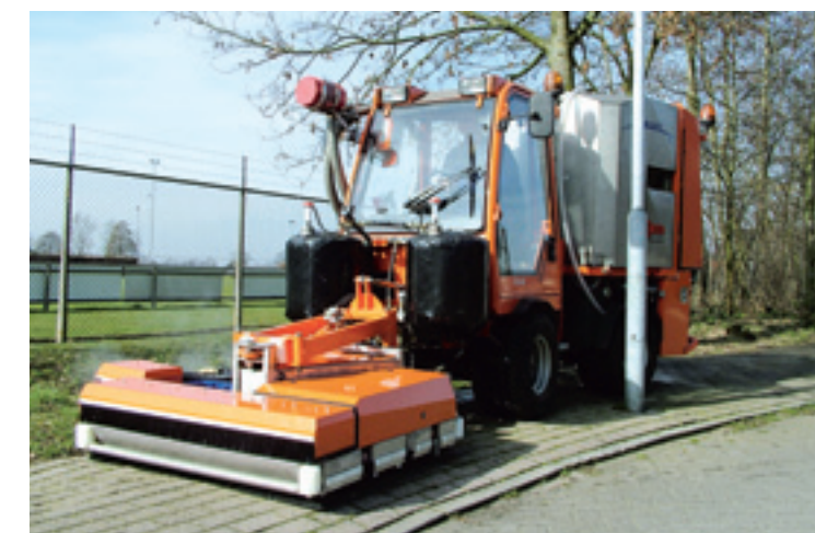
De Wave bestrijdt onkruid op verhardingen selectief met heet water. Het onkruid wordt als het ware gekookt waardoor er weinig volume achterblijft.
