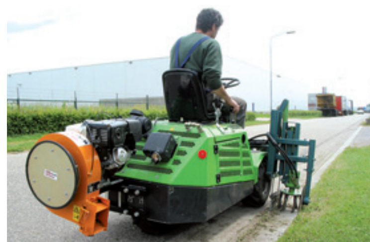
Overgroeide graskanten zijn te bewerken met de WeedTrac met kantensnijfrees. Deze snijdt met een schijf de kant af en borstelt het materiaal weg. Een blazer blaast het materiaal over het maaiveld.
