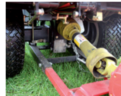
Voorop de machine zijn de hefinrichting en de doordraaiende aftakas geplaatst.
