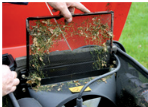
De radiator is afgeschermd met een rooster dat het meeste vuil, zoals gras en bladeren, tegenhoudt. Los halen gaat met twee vleugelmoeren.
