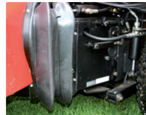
Achter de vooras zijn de cilinders van de hefinrichting geplaatst. Linksboven in de foto is de cilinder van de knikbesturing te zien.
