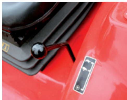
De transmissie heeft een hoge en een lage groep. Met de hendel links naast de bestuurder kun je schakelen.
