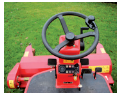
Het handgas zit rechts naast het stuur. Links en rechts tegen de console zitten beide rempedalen. De blokkering zit voor het rechterpedaal. Met de twee rechterpedalen kies je de rijrichting.
