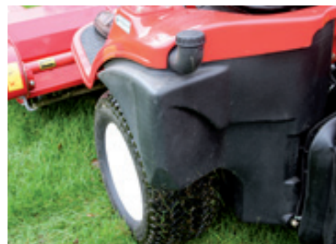
De brandstoftank is in de machine geïntegreerd. Deze heeft een inhoud van 50 liter.
