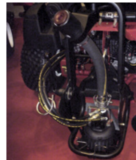
Toro presenteerde de bunkerrake Sand Pro 3040 & 5040 waaraan verschillende machines en gereedschappen kunnen worden bevestigd. Op het nieuwste model kan een pomp om water uit de bunkers te verwijderen na een hevige regenbui.
