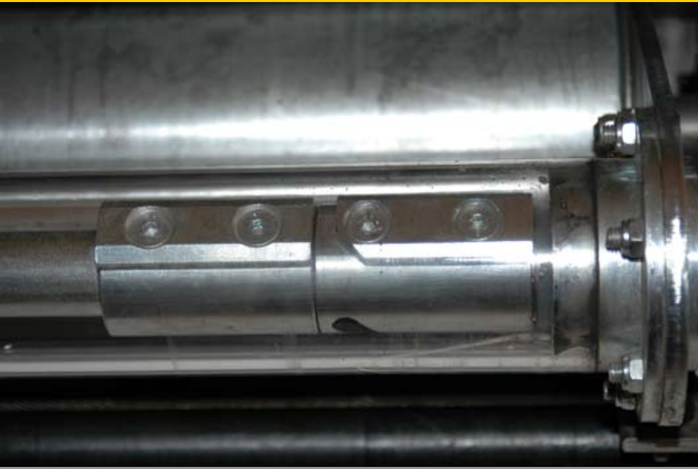
De uitwendig geplaatste as (6000 rpm) in kunststof behuizing wekt met de verplaatsbare gewichtjes ide trillingen op.
