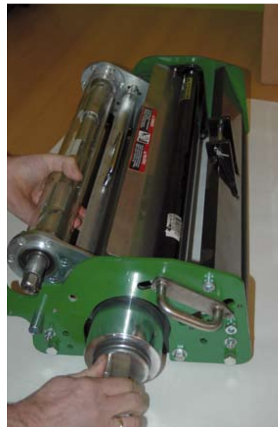
De complete Vibrating Roller zoals die aangebouwd kan worden.
