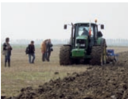
Foto 7. Grondbewerking met te hoge bandspanning van 1,6 bar: veel wielslip, vollopende banden, minder rijcomfort en meer brandstofverbruik.
