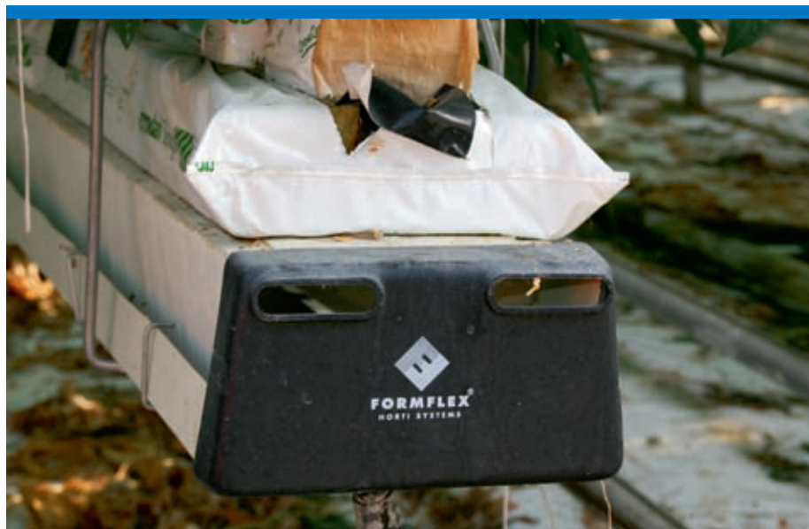
Aarts ontwikkelde samen met Formflex de AG-goot. "Wij hebben de goot als het ware ondersteboven gelegd. Het water uit de mat wordt naar de onderkant afgevoerd en daarna pas naar achter."
