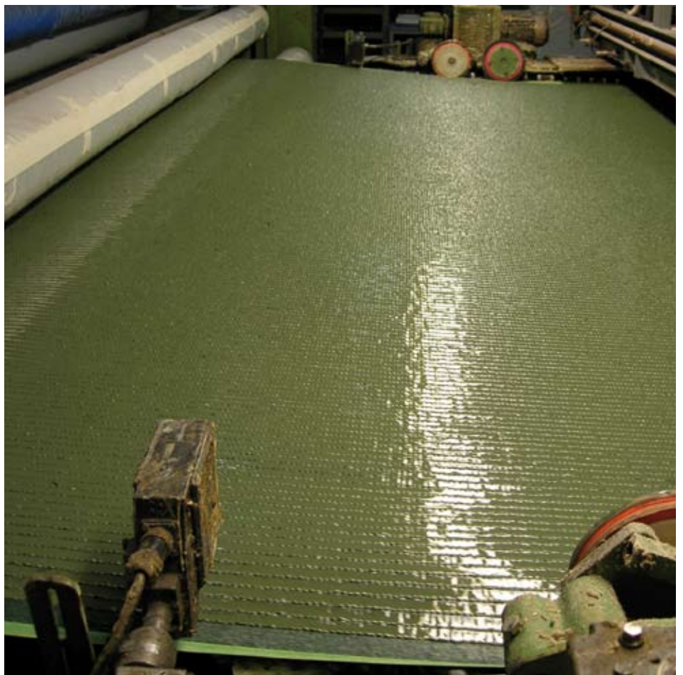
Stap 4: Het gecoate doek net na de applicator, vlak voordat het de oven in gaat. Rechts een stuk van de oven. Stap 5 gebeurt zodra het doek uit de oven komt: dan vervolgt het zijn weg via een spaarbakken naar de 'oprol': hier wordt het doek afgesneden, opgerold en verpakt.
