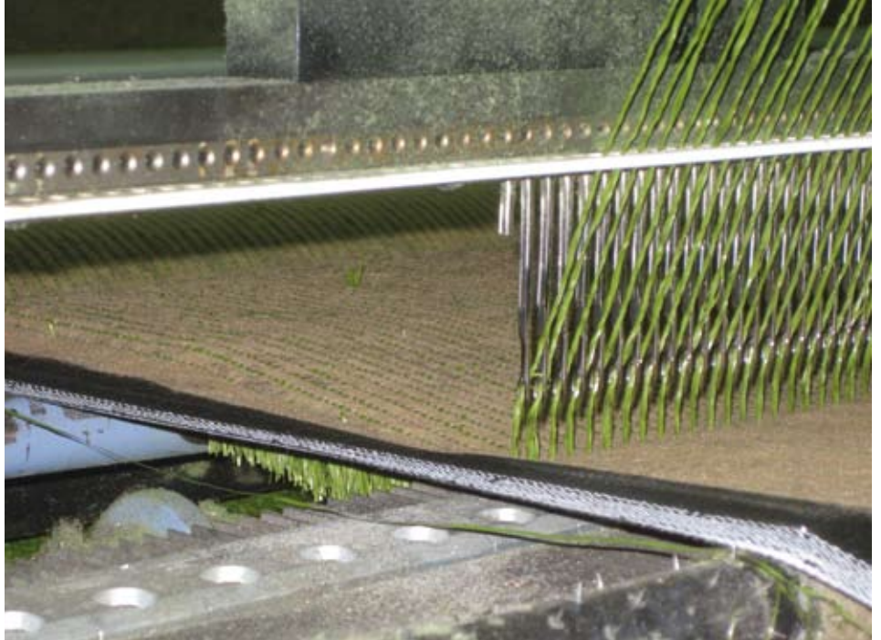
Stap 2: Honderden naalden tuften het garen in het doek. Aan de onderkant wordt het garen doorsneden.
