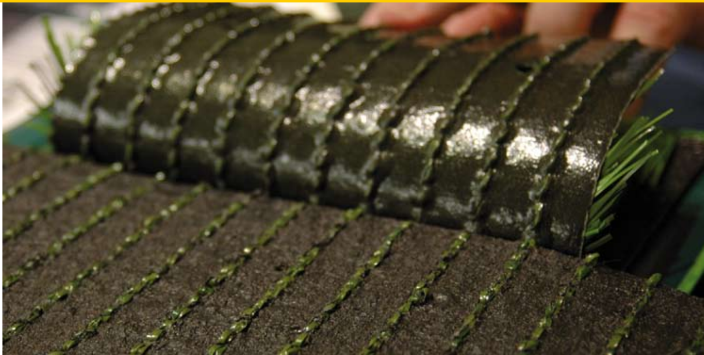
Onder tuftdoek met latex-backing, boven tuftdoek met PU-backing. De PU-backing voelt dikker en gladder aan.
