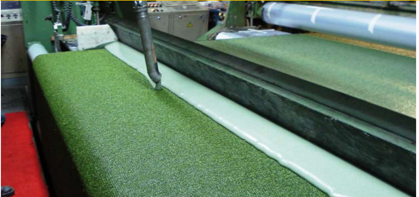
Stap 3: De PU-applicator brengt polyurethaan aan op de onderkant van het tuftdoek. Achter de zwarte rakel –verdeler van de opbrengst voor egaliteit- zitten densiteitsmeters die meten hoeveel massa is opgebracht
