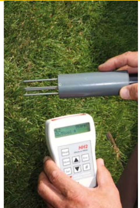
De vochttoestand meten in de wortelzone met een bekabeld of draadloos sensornetwerk. Handmatig kan ook.
