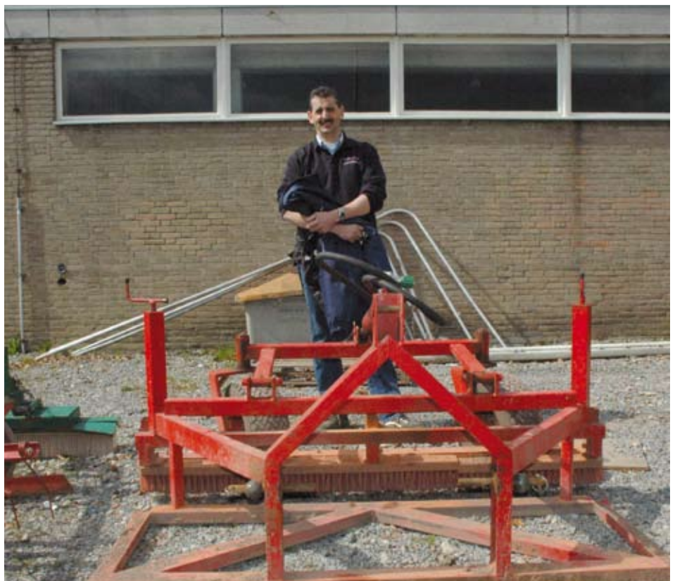
Een van de groengereedschappen die de gemeente Breda heeft ontwikkeld in samenwerking met bedrijven uit de regio: een sleep- en egalisatiepraam in een.
