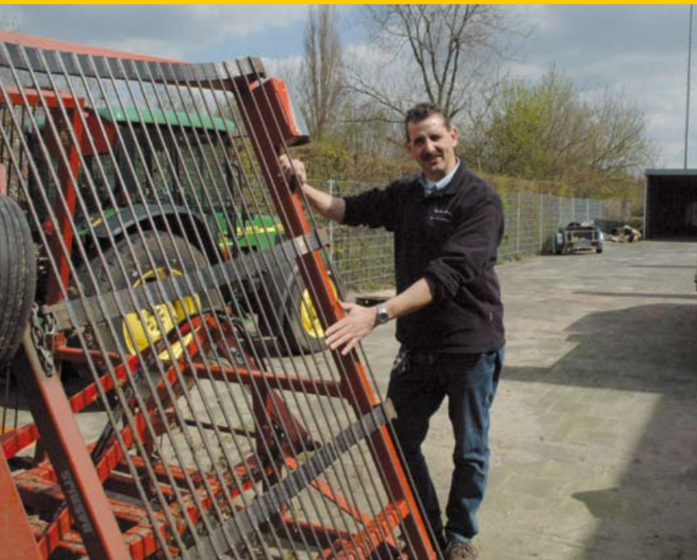
Een van de groengereedschappen die de gemeente Breda heeft ontwikkeld in samenwerking met bedrijven uit de regio: een zandsleepmachine die een raam met tralies bevat, weggenomen uit een aardbeeroomachine.
