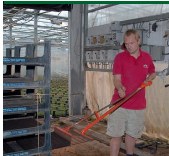
Op een aangepaste pallet staan de kratten met de open zijde naar de buitenkant. De medewerker hoeft de pallet daardoor maar één keer te draaien om alle potten er vanaf de korte kant in te schuiven.
